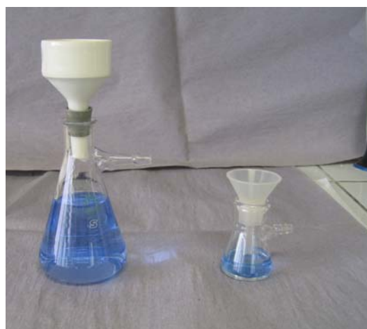
Fiole à vide de 100mL avec buchner et matériel de microchimie
