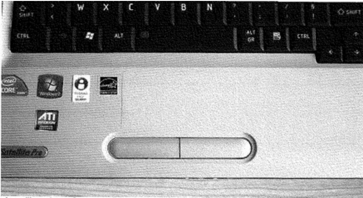
Au milieu : la surface sensible du TouchPad, avec ses 2 boutons vers l'utilisateur...
