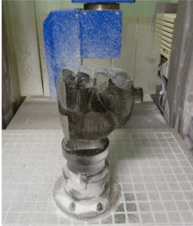
Usinage de la PLV du parfum Diesel dans un bloc de PMMA sur fraiseuse numérique
