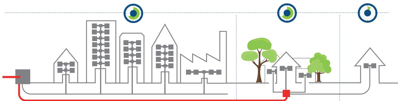
La montée en débit des années 2000 consiste à remplacer partiellement le réseau en cuivre par un réseau en fibre optique, afin d'améliorer les débits offerts jusqu'à apporter le Très Haut Débit à une partie des usagers d'une zone donnée. Une telle opération constitue une des solutions transitoires avant le déploiement du futur FttH.
