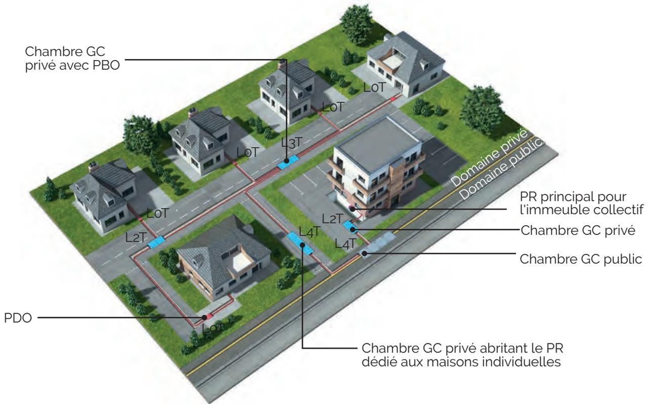
Fig. 103 | Synoptique d'un câblage type pour un campus privé composé d'immeubles et de locaux individuels sans PR commun
