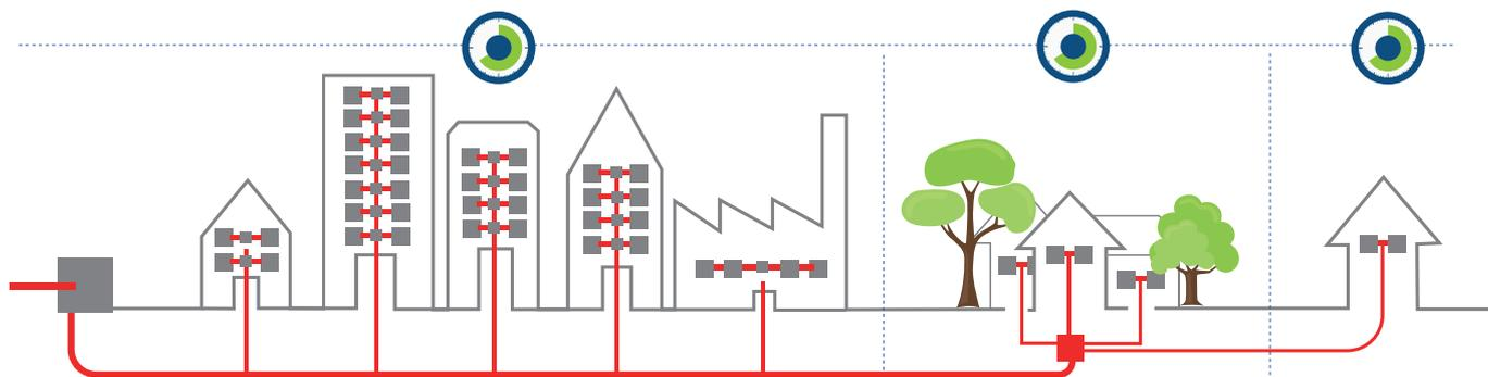
Compte tenu des engagements de déploiement pris par les opérateurs d'infrastructure, le FttH est l'infrastructure passive la plus performante à l'échelle nationale, permettant une garantie de débit indépendante du nombre d'abonnés raccordés ainsi que de la distance NRA - Abonné dans la limite des 20 Km communément admis.
