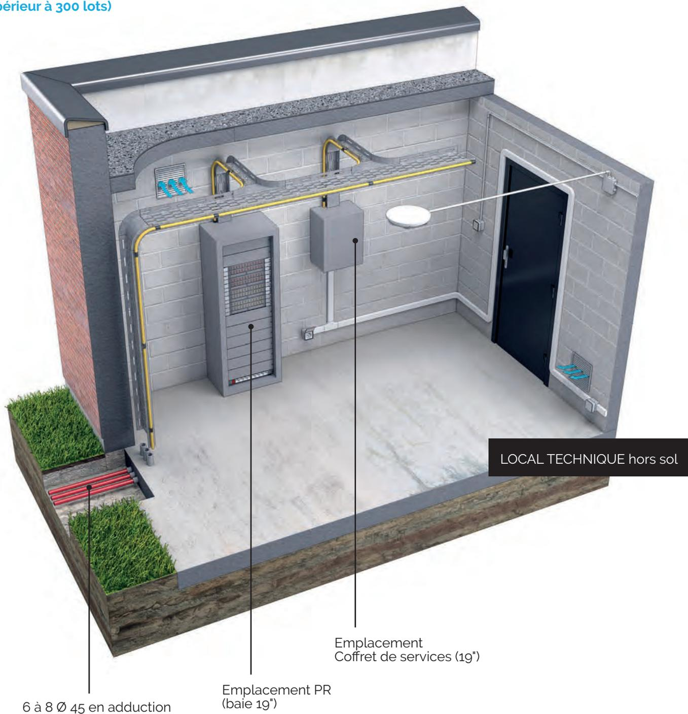
Dans l'emprise de son chantier, le Maître d'Ouvrage, bénéficiaire du projet d'aménagement construit le réseau de génie civil souterrain (du Point d'Accès Réseau au point de Démarcation). Il réalisera aussi la partie câblage du PR au PDO (avec si besoin la pose de PBO dès lors ou l'aménagement est supérieur à 10 accès/DTIo).
