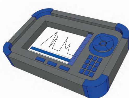
Le réflectomètre optique temporel (OTDR-Optical Time Domain Reflectometer) est l'outil essentiel à la caractérisation et à la certification de liens fibre. Il est important de sélectionner celui qui offre la performance adaptée en fonction des liens à tester et de son utilisation (détection de coupure, recette, supervision, maintenance).
