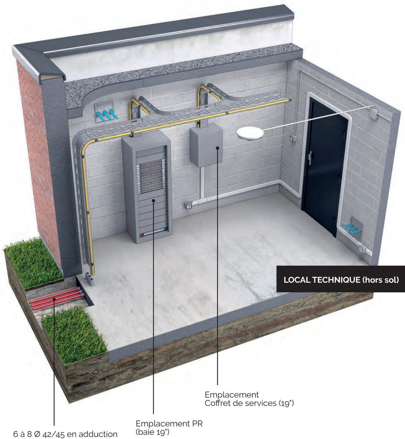
Fig. 87 | Exemple d'un PR à partir d'un répartiteur optique au standard 19".
