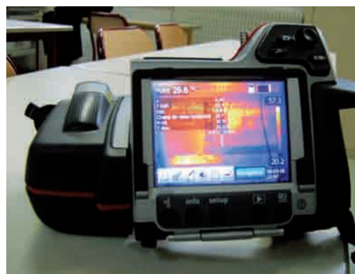
Thermacam T 400 ondes longues à matrice microbolométrique 320 x 240, module visible, écran tactile et mode fusion
