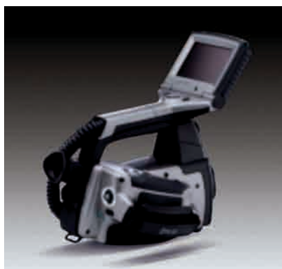
Thermacam P 60 ondes longues à matrice microbolométrique 320 x 240 et module visible
