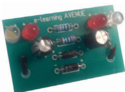
6 La carte électronique pilotant les feux de circulation
