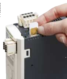
Duplication d'une application avec la carte mémoire VW3 M8 705
