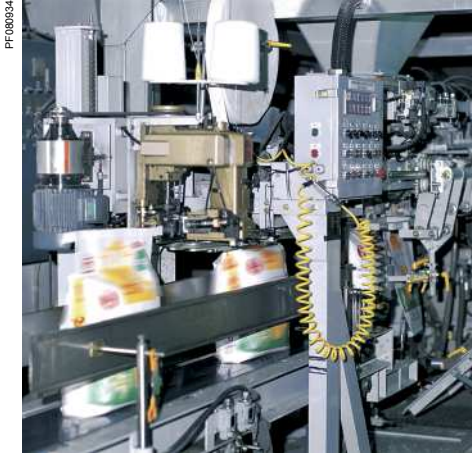
Servo variateur Lexium 32 pilotant une machine d'emballage
