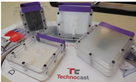
1 Les cadres permettent de réaliser des moules en silicone et des pièces en polyuréthane
