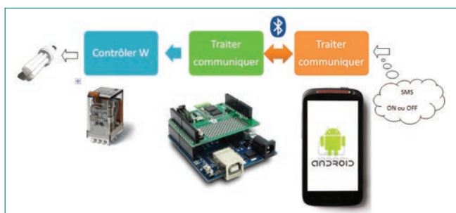
10 La chaîne d'information pour la commande d'une lampe à distance
