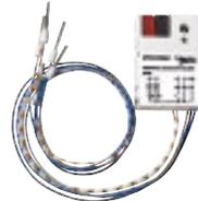
2 entrées binaires / 2 LEDs pouvant s'installer en fond d'une boîte d'encastrement pour relier un poussoir conventionnel à KNX
