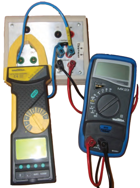
13 Le relevé des courants et des tensions de la chaîne d'énergie sur le boîtier de mesure
