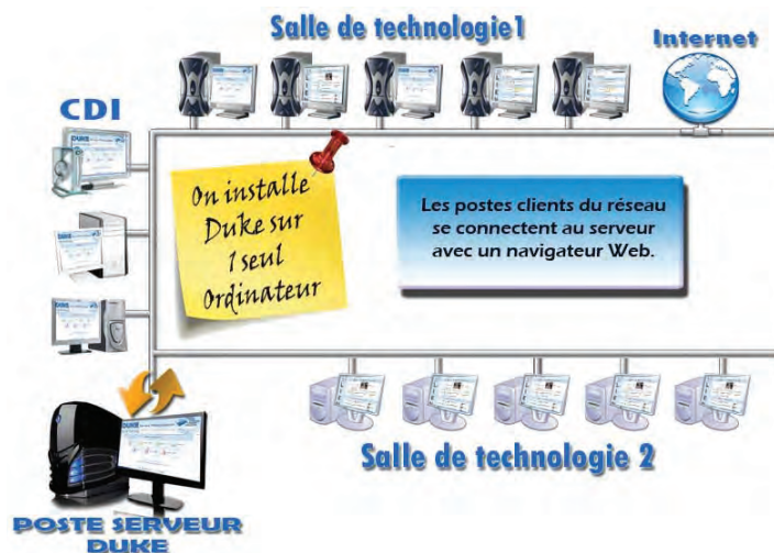
1 L'architecture du serveur Duke en salles de technologie
