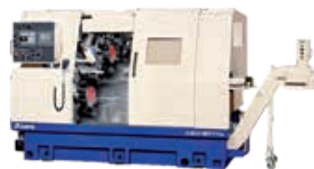
Doté de trois tourelles, ce centre de tournage dispose d'une commande numérique qui contrôle une dizaine d'axes. Source : Hestika
