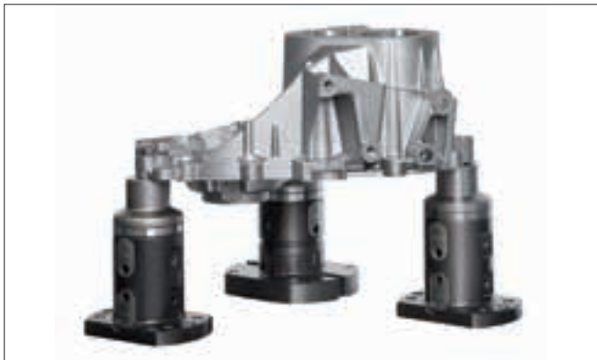
Modulaire, le système de bridage UNI lock s'adapte à une multitude d'applications d'usinage 5 axes. Source : Norelem
