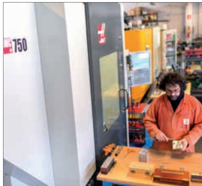
Le centre d'usinage 5 axes Haas UMC-750 permet d'effectuer davantage de tâches et est adapté à la fabrication complète de pièces complexes. Source : Capecchi Srl
