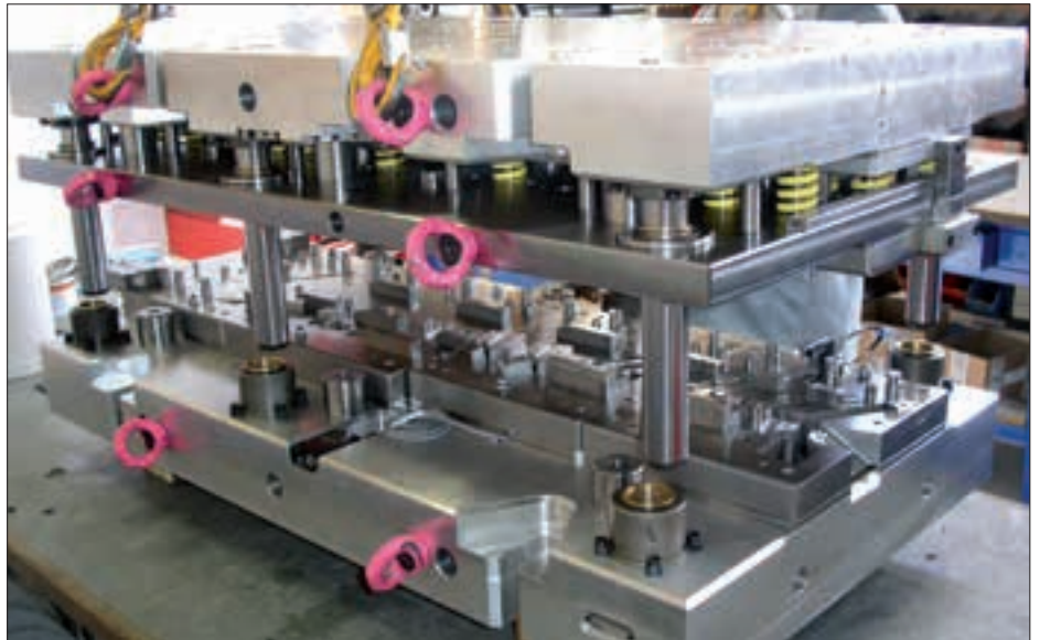
La conception et la fabrication des ensembles complexes, comme cet outillage de découpe, est un des atouts importants de sous-traitants microtechniques. Source : LAM
