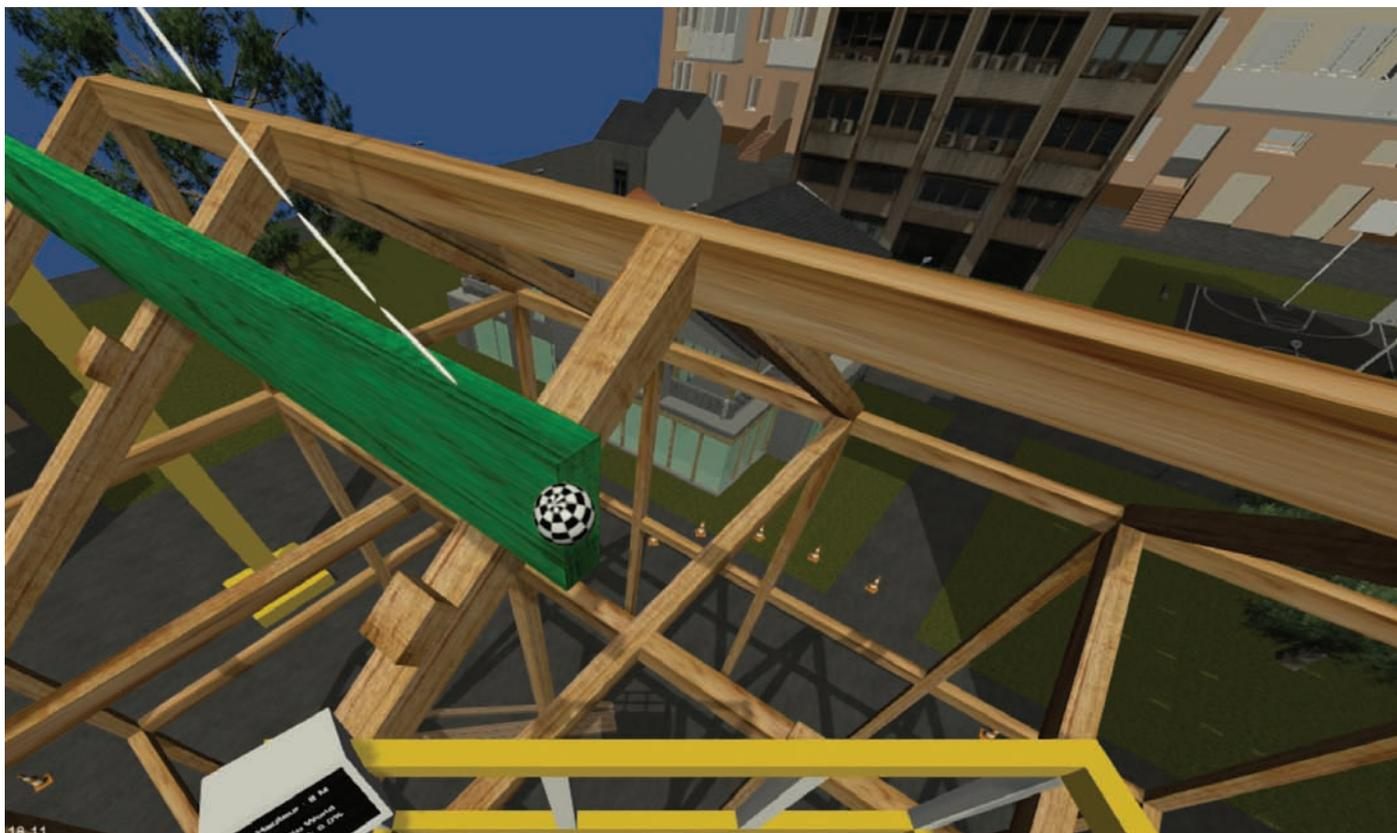
**5** Pose virtuelle d'une poutre dans une charpente lors de l'apprentissage du travail en hauteur à l'aide d'une simulation virtuelle en 3D (document Clarte, [www.clarte.asso.fr](http://www.clarte.asso.fr))
