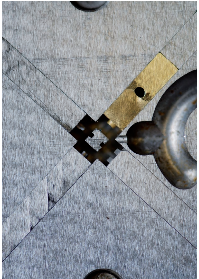
5 L'outillage d'injection du corps assemblé (les dimensions du carré central sont de 3 mm x 3 mm)
