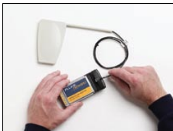
Figure 7 - Carte avec antenne unidirectionnelle externe
