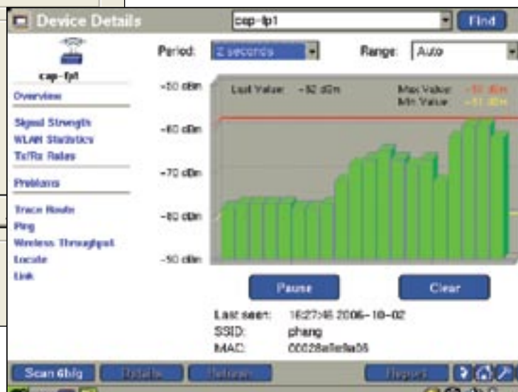
Figure 4 - Graphique qui représente l'intensité du signal, optimisé pour la détection des points d'accès non autorisés
