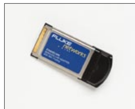
Figure 2 - Carte radio standard avec antenne omnidirectionnelle pour réseau local (LAN) sans fil
