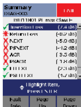
Figure 4 : A la fin de l'autotest, l'écran du testeur affiche la liste des paramètres de test mesurés pour le test sélectionné. Les paramètres de test marqués d'une croix rouge présentent des résultats non conformes. Le testeur affiche également entre parenthèses la plus mauvaise marge pour chaque paramètre du côté droit de l'écran.
