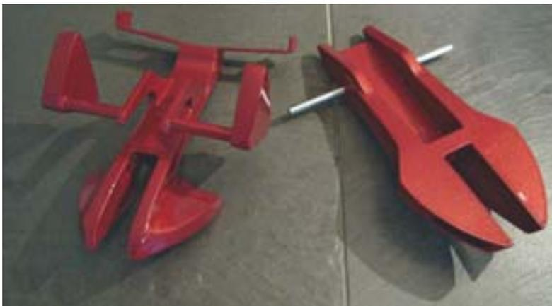
**17** L'évolution des formes du châssis pour prendre en compte les contraintes de fabrication
