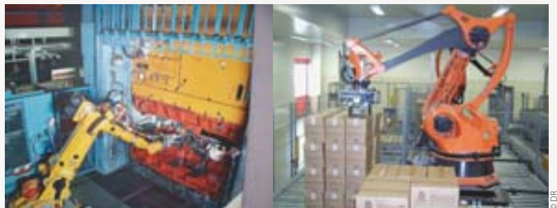
SILHOUETTE. Après avoir fait appel à un cabinet de design, le robot Kuka KR180PA perd son allure germanique (à gauche, en 1993) et prend des courbes plus arrondies en 1998 (à droite)
