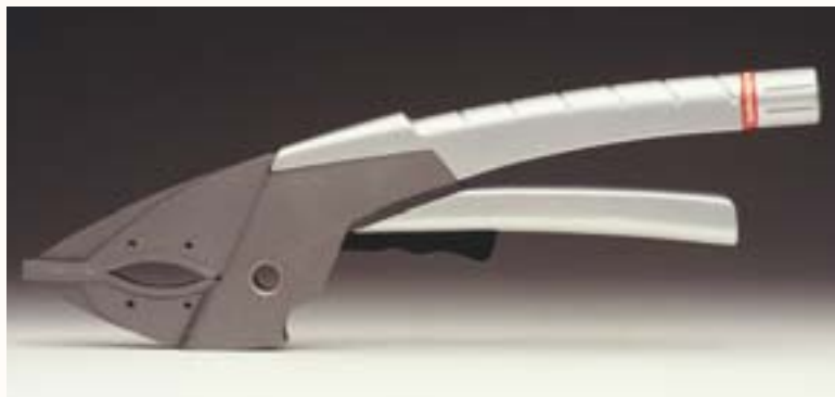
La cinématique de pince est une belle prouesse technique (20 kg sous la main pour 300 kg dans les mors et un serrage d'un diamètre de 40 mm)
