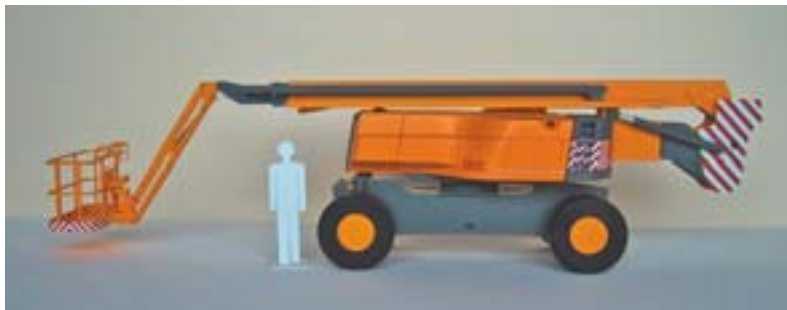
8 La maquette échelle réduite permet de valider des choix qu'il est difficile de faire sur les dessins
