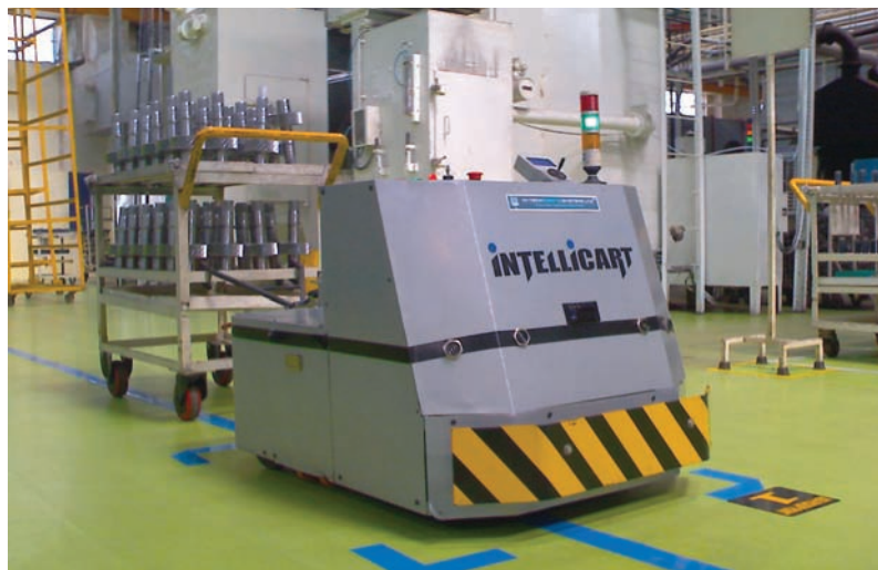
1 Un système de transport filoguidé dans une entreprise
