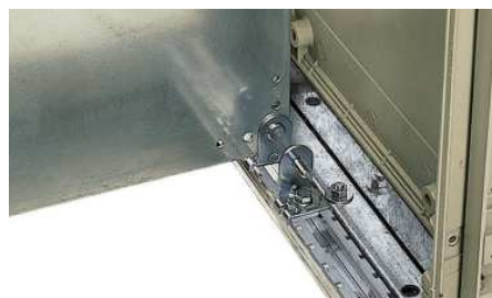
Châssis plein monté sur barreaux crantés et platines d'adaptation obligatoires dans toutes les armoires avec partie inférieure ouverte.
