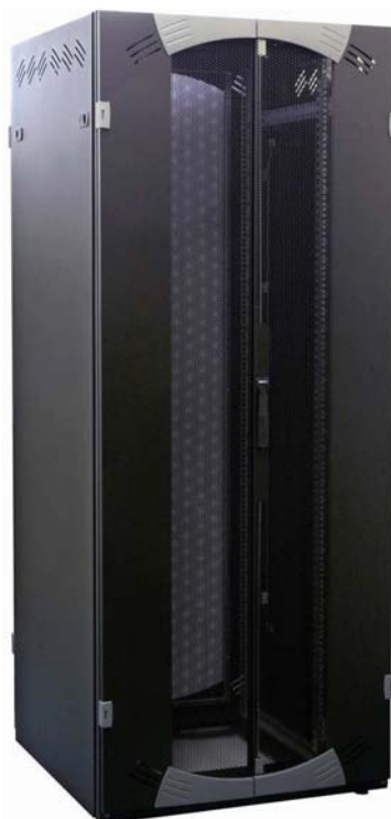
Baie de hauteur 42 U, largeur 800 mm et profondeur 1000 mm avec porte double microperforée et fermeture par poignée à code de 3 chiffres.
