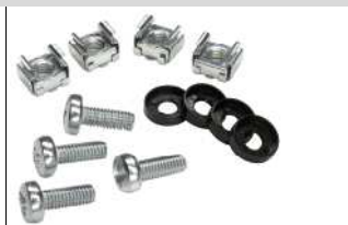
visserie de fixation sur châssis 19" sachet de 50 vis M6 x 16 rondelles et écrous-cage M6 NSYGFR95M65
