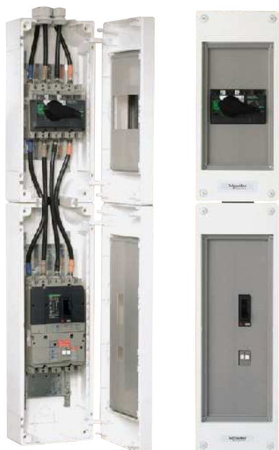
Exemple d'installation d'un Interpact INV + Vigicompact dans 2 coffrets d'interface. Références nécessaires : coffrets d'interface PRA06224 et PRA06324 + Kit "Interpact" PRA90068 + kit "Vigicompact" PRA90069 + liaison 04149
