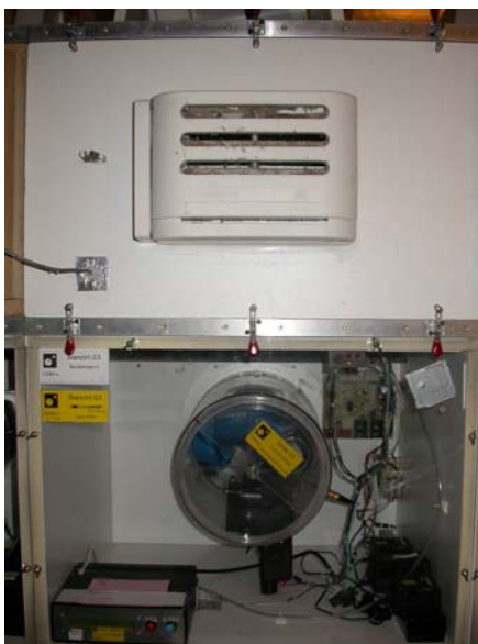
Figure 58 : Banc de mesure de débit en salle hygroréglée
