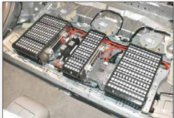
Batterie Ni-Mh d'une LEXUS
