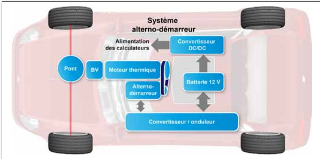
Synoptique d'un véhicule micro-hybride
