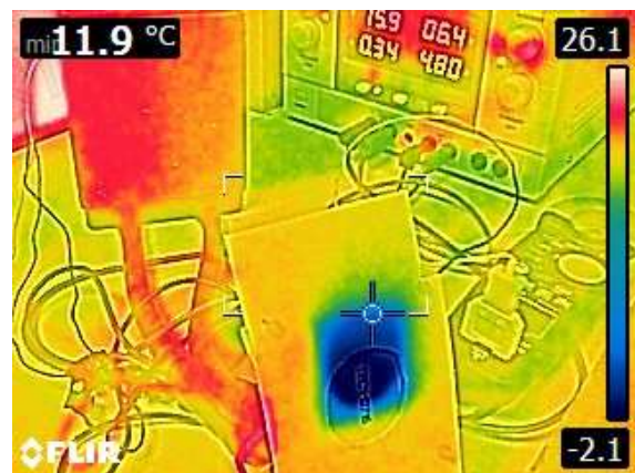
fig 17. TEC12715 avec son dissipateur sous 4.8A et 6.4V avec refroidissement à eau et ventilateur alimenté en 15.9V et consommant 0.34A pour avoir une température froide de -2.1°C avec une température ambiante de 20°C
