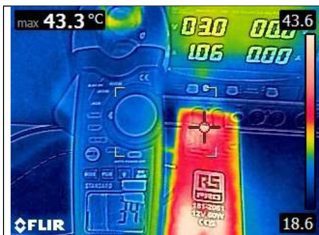
Mesure température film résistant 60W/12V
