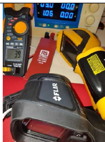
Mesure température film résistant 60W/12V
