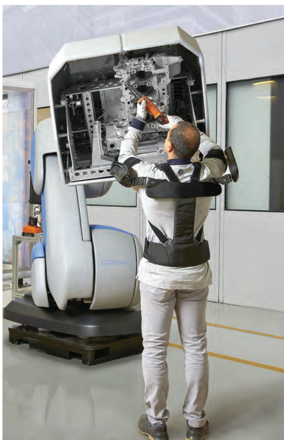
1 Les exosquelettes passifs sont des systèmes à ressorts ou à élastiques qui se portent sous forme de harnais.
