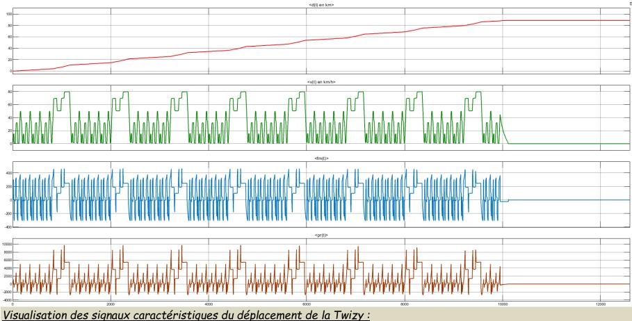
L'autonomie obtenue à la succession de cycle NEDC dans ce cas d'utilisation est de 88,8 km, inférieure à la valeur trouvée lors de la simulation précédente (seuil d'utilisation batterie réglée à 3 % auparavant) ;
