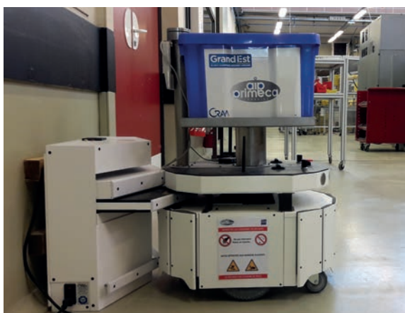
2 AGV : Véhicule guidé automatiquement
