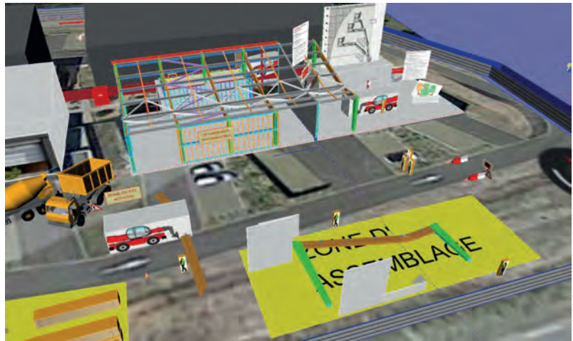
14 Exemple de préparation chantier 3D « Domolandes SCBH2 »
