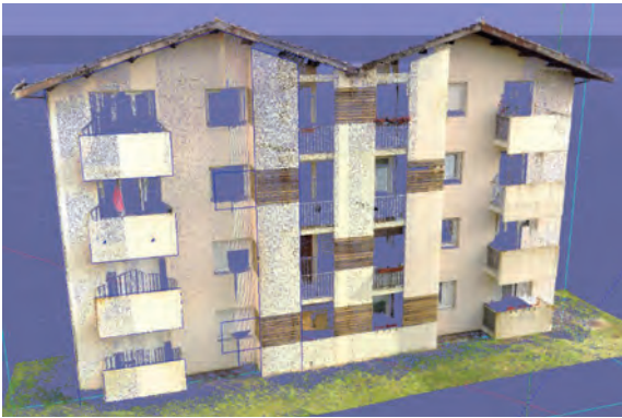
12 Nuage de points pour une réalisation d'une ITE ; on construira directement sur le nuage la solution ITE prévue
