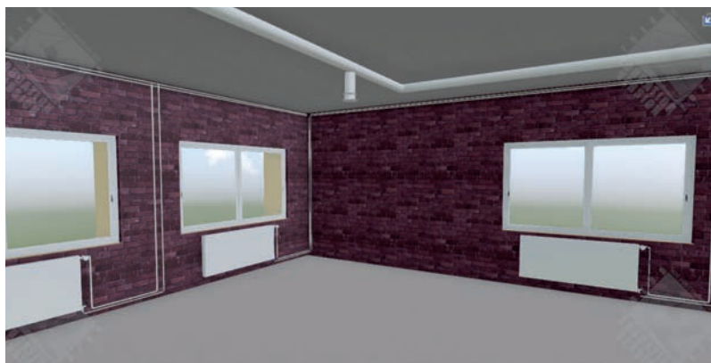
16 Vérification de l'implantation des radiateurs et des canalisations (Autodesk Revit/Fuzor)
