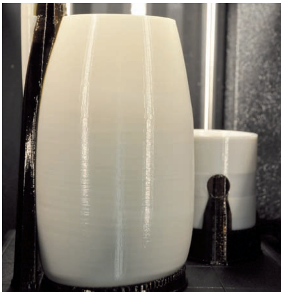
3 Les 2 pièces du carter d'un propulseur réalisées sur machine de prototypage rapide par fil ABS
