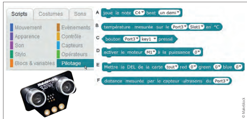
6 Exemples de blocs d'instructions utilisés pour programmer le robot mBot avec le logiciel mBlock
