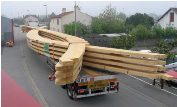
31 Transport de charpente en bois lamellé-collé
