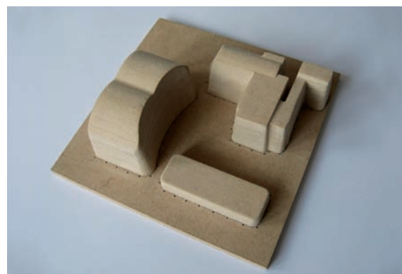
6 L'outillage nécessaire au thermoformage du blister, réalisé en stratoconception
