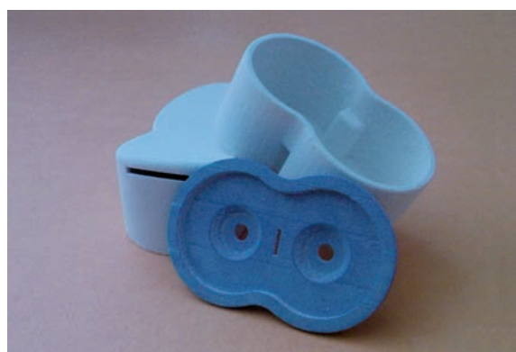
5 Le corps et le couvercle du Flash-up réalisés en prototypage
