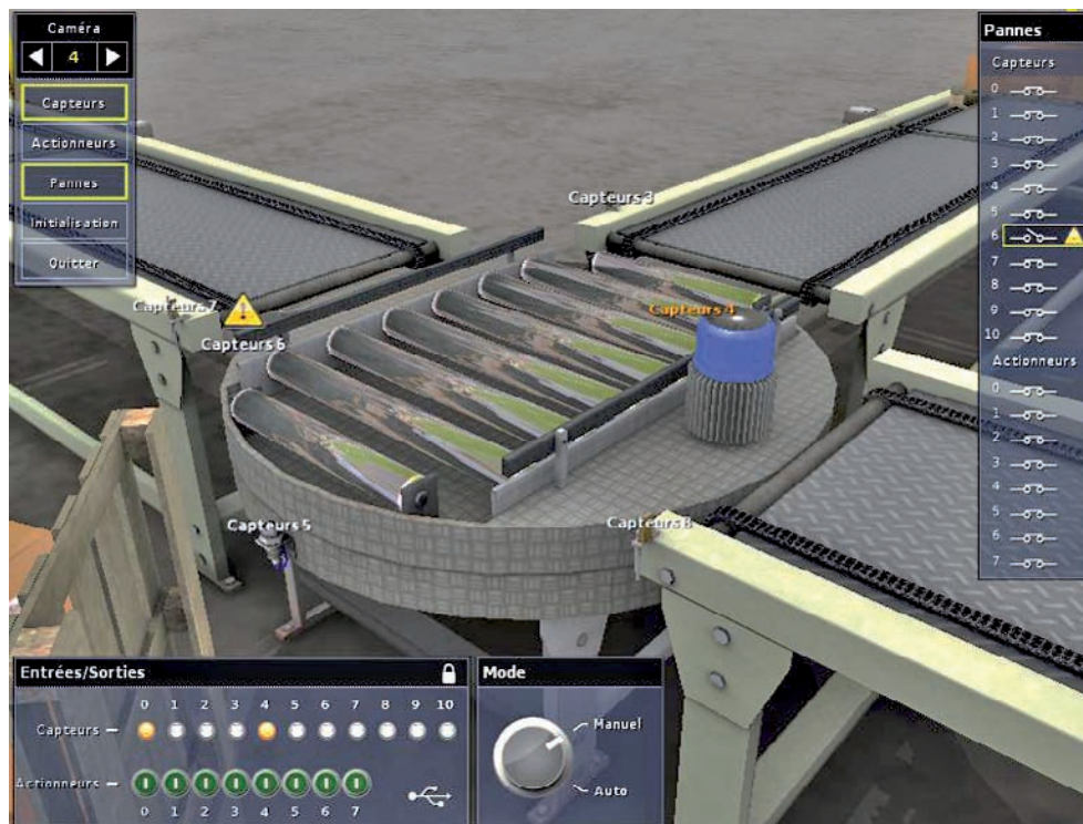
11 La chute de caisse provoquée par la panne du capteur s6
