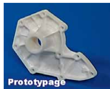
2 Un corps de pompe à eau : modélisation Catia du produit industrialisé (à gauche), composant prototypé (à droite)
