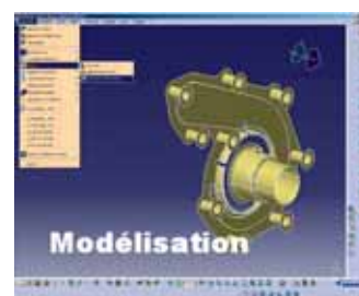
1 Un corps de pompe à eau : composant mécanique et pièces adjacentes (à gauche), modélisation Catia des surfaces fonctionnelles (à droite)
