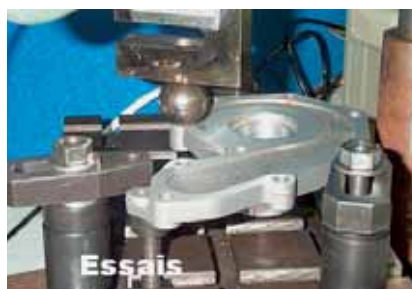
3 Un corps de pompe à eau : test de sollicitation mécanique (à gauche), calcul par éléments finis sous Catia (à droite)
