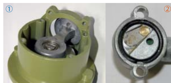
7 La compression des gaz : les clapets
