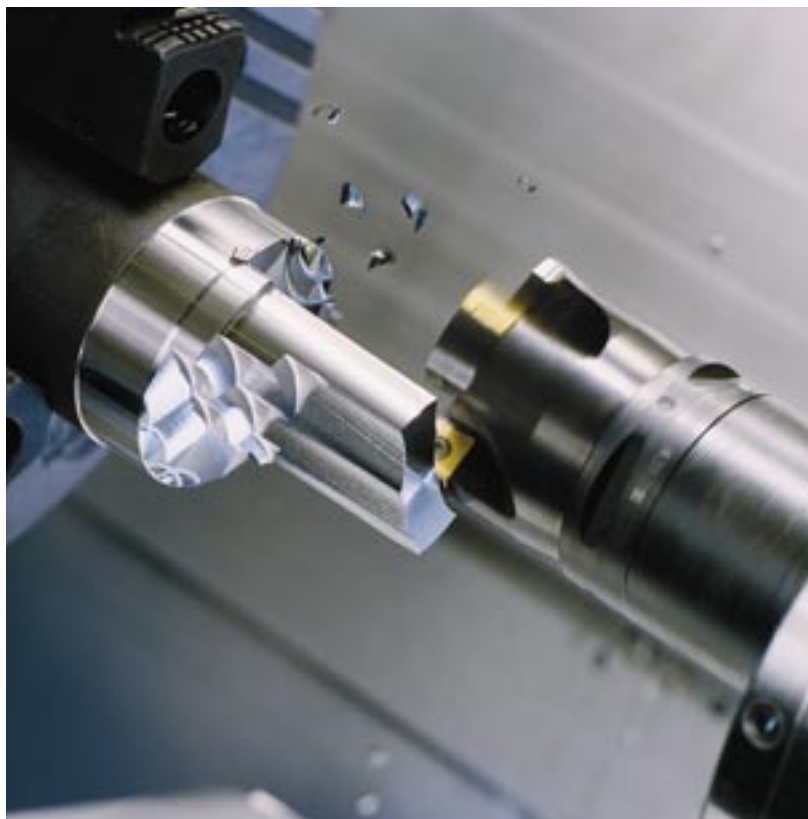
■ Tréflage et surfaçage. La fraise CoroMill 210 de Sandvik Coromant assure des opérations d'ébauche et de finition avec des avances importantes
