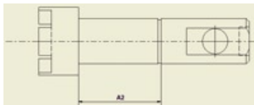
▲ Figures 15 et 16. Le report des cotes sur les pièces 1 et 2
