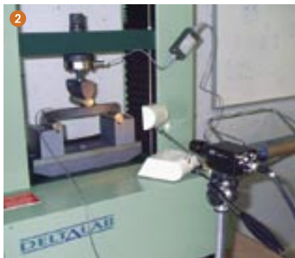
Photo 1. Le montage de flexion 3 points
