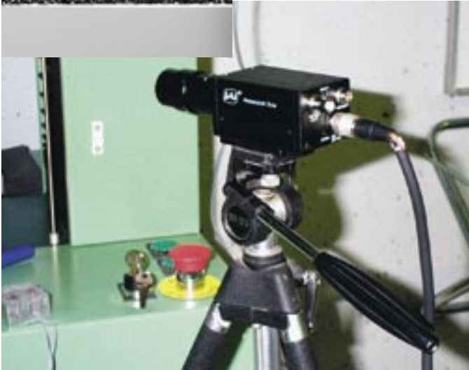
▲ Photo 6. On suit ce mouchetis au cours de la déformation grâce à la caméra CCD
