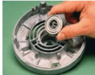
▲ Figure 6. Le collage d'un roulement dans un palier en aluminium
