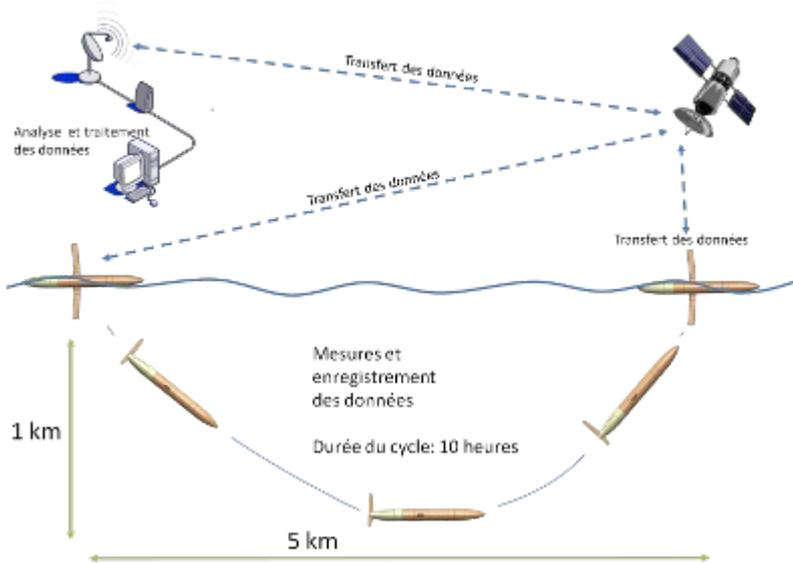
Lors de la phase de surface de son cycle de fonctionnement, l'hydroplaneur communique avec sa base terrestre ou marine (position, données).
