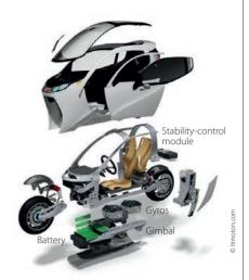
leffet gyroscopique est utilisé dans beaucoup de domaines pour stabiliser un objet en maintenant son orientation dans un repère galiléen. C'est l'effet qui permet à une toupie de rester verticale en équilibre tant qu'elle tourne suffisamment vite. L'effet gyroscopique est notamment utilisé pour stabiliser des caméras, repérer l'inclinaison en vol des avions et orienter des satellites.
