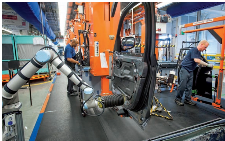
■ Le bras robotisé UR doté de 6 axes est actuellement utilisé par BMW aux États-Unis. Il travaille en toute sécurité à côté des employés pour le montage des portières.
