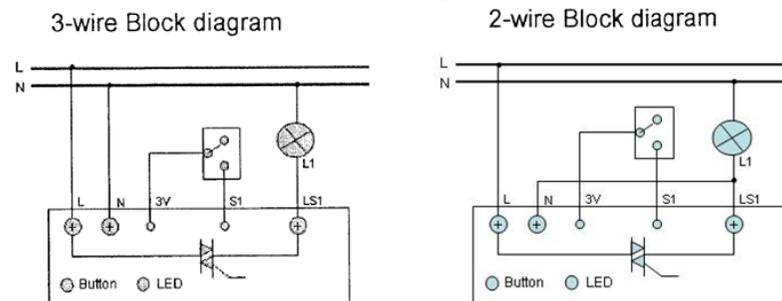
Comme illustré dans le diagramme ci-dessus, S1 permet une connexion de l'interrupteur mural aux contacts secs. Par défaut, l'interrupteur pris en charge doit être de type SPDT (Single-Pole-Double-Throw). Cependant, le paramétrage de la Passerelle permet de configurer S1 pour prendre également en charge les interrupteurs à bascule.
