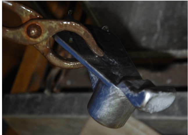
Figure 14 : Ouverture du moule
