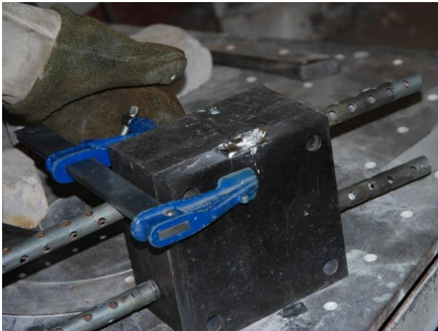
Figure 11 : Coulée configuration « masselotte sur l'éventail sans broche »
