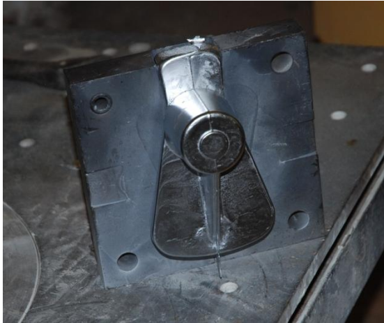
Figure 14 : Ouverture du moule
