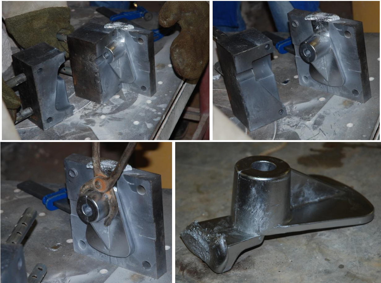
Figure 8 : Ouverture du moule
