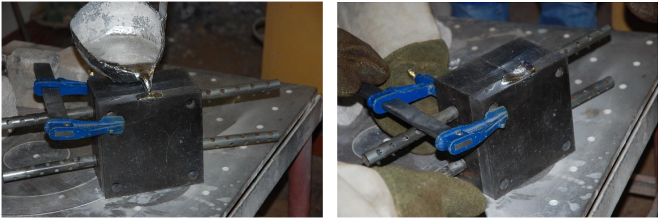
Figure 7 : Coulée configuration « masselotte sur le cylindre et avec broche »
