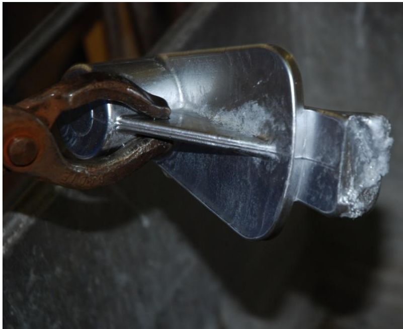
Figure 12 : Ouverture du moule
