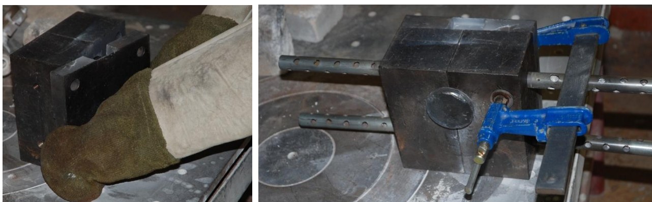
Figure 5 : Assemblage de la coquille
