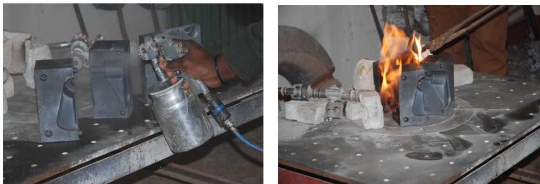
Figure 4 : Application du poteyage à l'aide d'un pulvérisateur à air comprimé
