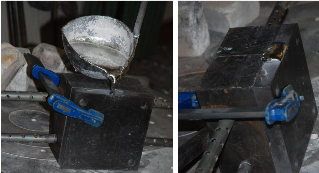
Figure 9 : Coulée configuration « masselotte sur l'éventail et avec broche »
