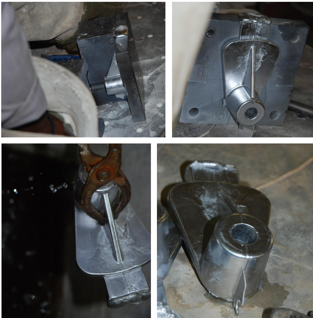
Figure 10 : Ouverture du moule
