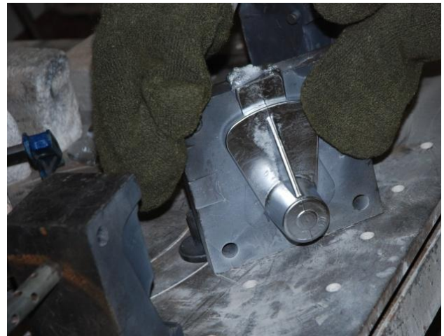
Figure 11 : Coulée configuration « masselotte sur l'éventail sans broche »
