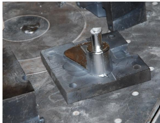
Figure 16 : Ouverture du moule
