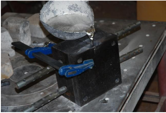
Figure 13 : Coulée configuration « masselotte sur le cylindre sans broche »
