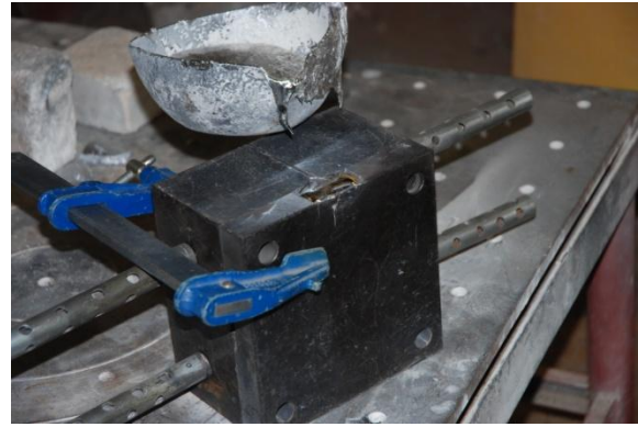
Figure 13 : Coulée configuration « masselotte sur le cylindre sans broche »
