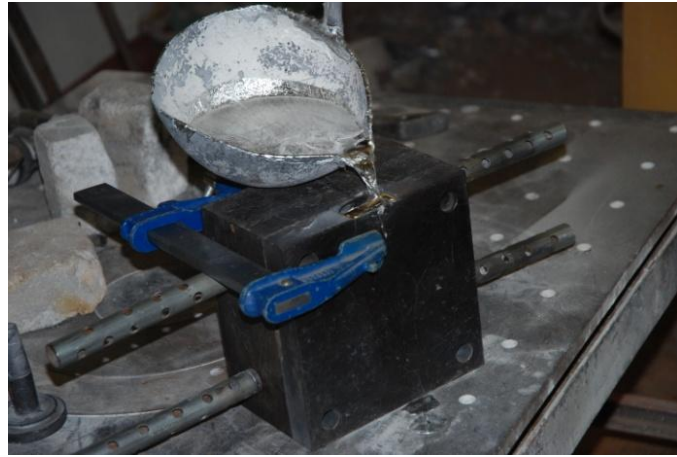
Figure 11 : Coulée configuration « masselotte sur l'éventail sans broche »
