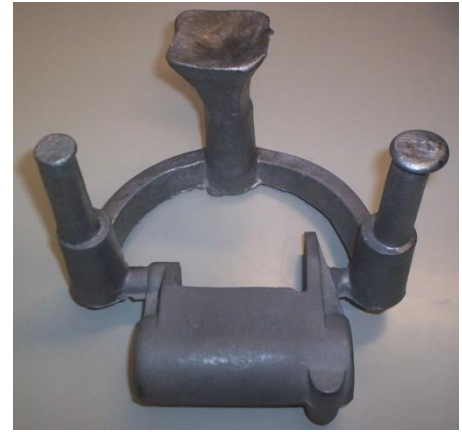
Figure 13 : Plaque modèle métallique pour moulage en sable (avec boîte à noyau) et la pièce obtenue.
