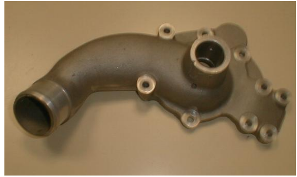
Figure 24 : Corps de pompe à eau en ALS17Mg obtenu par moulage à la cire perdue, brut et après finitions
