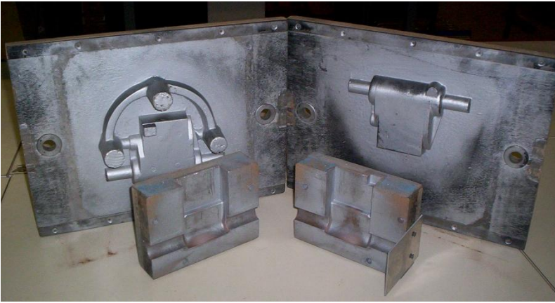
Figure 13 : Plaque modèle métallique pour moulage en sable (avec boîte à noyau) et la pièce obtenue.
