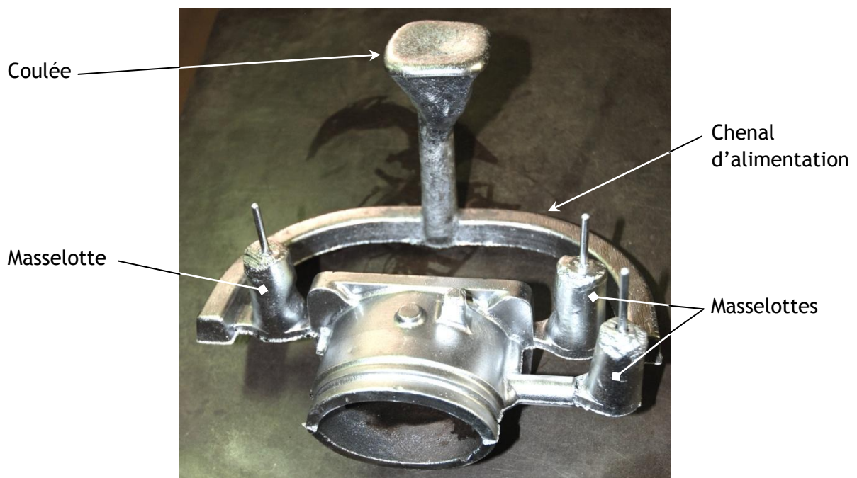
Figure 10 : Pièce en sortie de moule avec masselottes, coulée et chenal d'alimentation, image HHM
