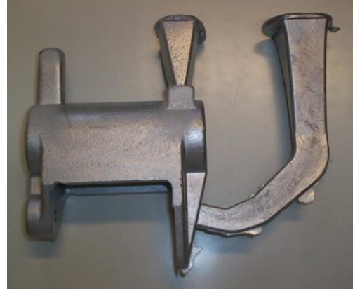
Figure 11 : Moule en coquille et boîte à noyau ouverts, et la pièce obtenue brute de moulage.
