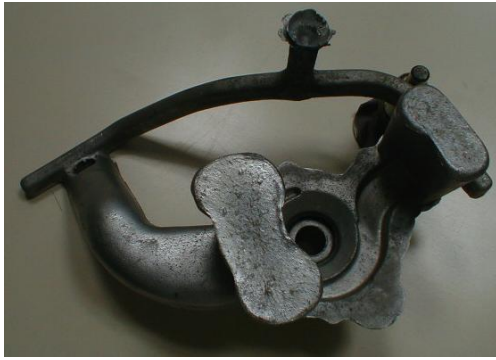
Figure 24 : Corps de pompe à eau en ALS17Mg obtenu par moulage à la cire perdue, brut et après finitions
