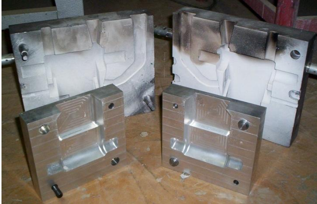
Figure 11 : Moule en coquille et boîte à noyau ouverts, et la pièce obtenue brute de moulage.
