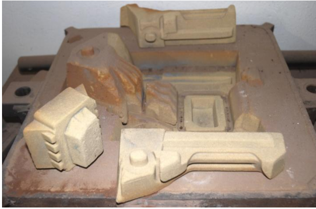
Figure 16 : Exemple d'assemblage de noyaux et pièce obtenue, images HHM
