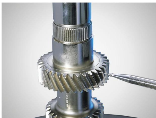
Figure 1 : Contrôle par un poste universel Margear GMX 600, image Mahr [1]
