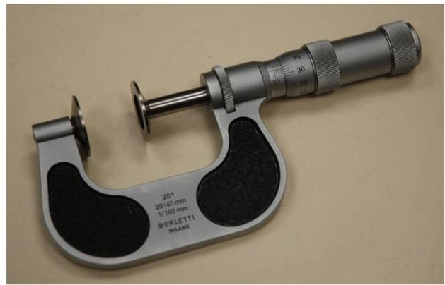
Figure 9 : Mesure sur 3 dents, à l'aide d'un palmer à plateau Borletti, image HHM
