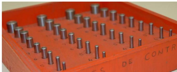
Figure 5 : Piges de contrôle diamètre 3 à 14 mm, image HHM
