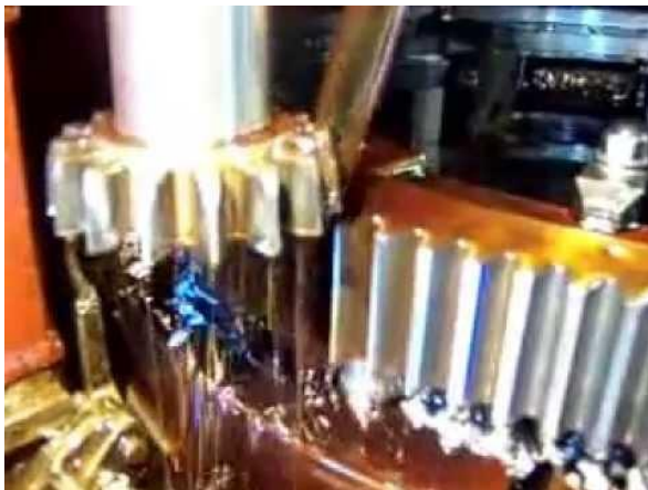
Figure 8 : Exemple de taille avec outil pignon, source [4]
