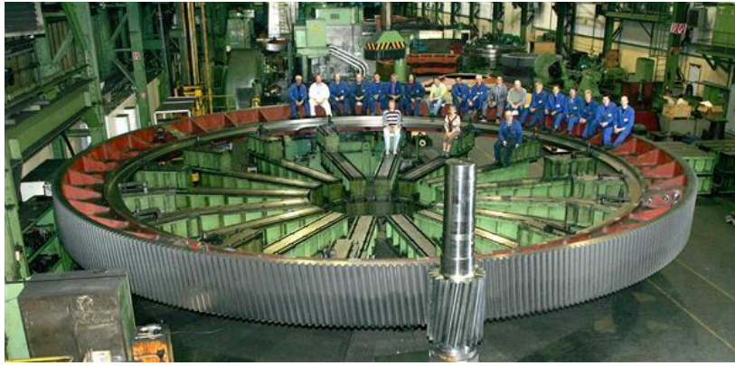
Figure 7 : Diamètre voisinant 13 m, largeur de denture de 89 cm, image Ferry Capitain [3]
