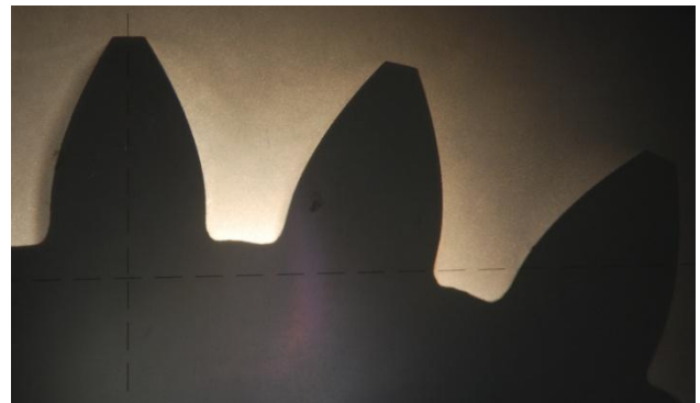
Figure 10 : Dépouille des dents de l'outil pignon et son profil en développante de cercle, images HHM
