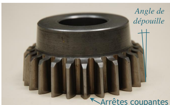
Figure 10 : Dépouille des dents de l'outil pignon et son profil en développante de cercle, images HHM
