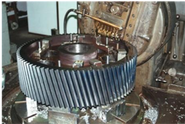
Figure 6 : L'outil sur la machine est incliné à droite, la roue usinée est à dentures à gauche
